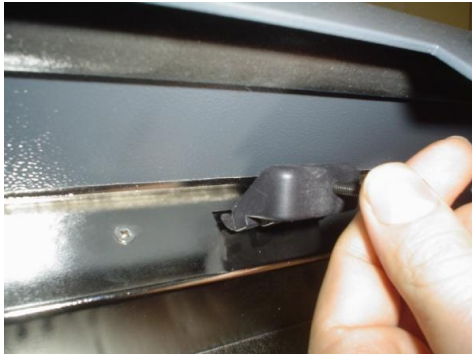
Figure102:Replacing the Display 更换显示器
