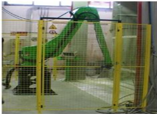
Figure18:Perimeter protection 周边保护
